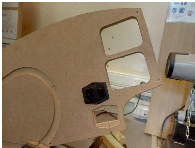
Figure 40, Test de taille de la connectique IEC dans une chute de MDF
