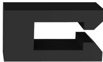
Figure 21, Clip de maintien de deux plaques de plexi
