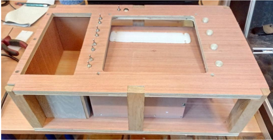
Figure 46, Corps avec alimentation fixée, planche pour ruban LED et plaque test de porte logique
